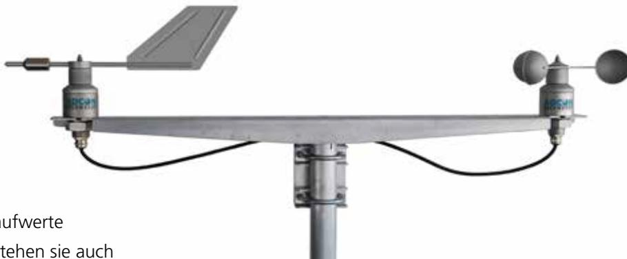
Die Materialien sind durchwegs seewasserfest, die Lager gekapselt und verschleißfrei, die beiden Meßelemente - Windfahne und Schalenstern - können selbst im Feld leicht getauscht werden. Das Set wird standardmäßig mit einer 80cm langen Masttraverse geliefert. Das Anschlußkabel ist mit dem Adcon-typischen 7-poligen Binderstecker versehen, mit dem die Sensoren an alle RTUs der Typen A72x, A75x sowie A733 angeschlossen werden können.
