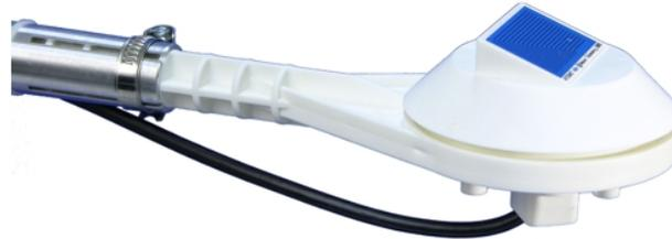
Der ADCON Blattnässesensor mit geringem Wartungsbedarf wurde als robuste Alternative zu herkömmlichen Blattnässesensoren auf Papierbasis entwickelt. Ein Netzwerk von Leiterbahnen, eingätzt in die Oberfläche eines schräggestellten, mit Teflon beschichteten Plättchens, simuliert so nah wie möglich die Oberfläche eines Blattes. Als Ausgangssignal erhält der Benutzer Werte zwischen 0 und 10.
