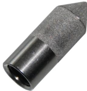
Oft ist ein TR1 Kombisensor (Temperatur/Feuchte) einer extremen Mischung aus Staub und mechanischer Belastung ausgesetzt, der konventionelle Filter normalerweise nicht gewachsen sind. Für diese Fälle gibt es nun den Edelstahlsinterfilter.
